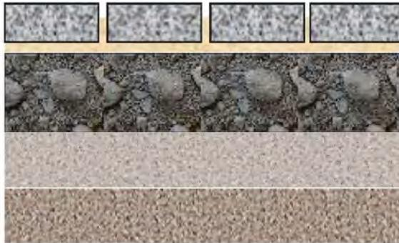
1 Deckschicht: Pflaster mit Fuge
