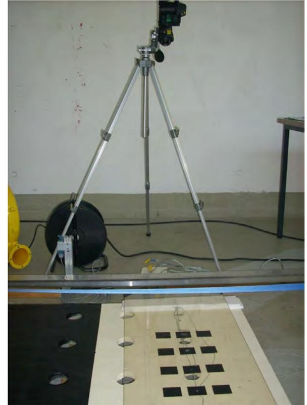
Versuchsaufbau zur Erfassung der Temperaturen bei Infrarot-, Heißschaum- und Heißwassergeräten (*in Erprobung*).
