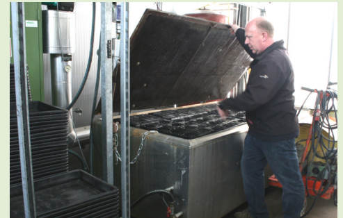
Abb. 1: Vermehrungsplatten im Heißwasserbad
