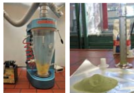
Abb. 6: Wirbelschichttrocknung von Trichoderma -Konidien für eine Flüssigsuspension (Mitte) oder Coating flüssigformulierter Biomasse auf Hirse zur Herstellung eines Bodengranulates zur Drahtwurm- oder Engerlingsbekämpfung (rechts, sporulierender Pilz)
