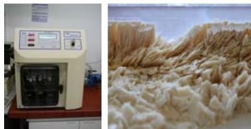
Abb. 5: Gefriertrocknung von Submerssporen von Isaria fumosorosea
