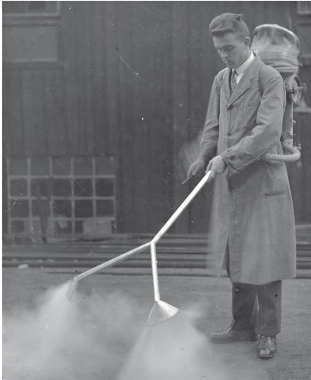
Motorpulververstäuber „Sulfamotor“ der Firma Platz. Ein 1,25 PS starker Motor treibt ein Rührwerk an, mit dem der Stäubeschwefel aufgemischt wird, und ein Gebläse, das den aufgemischten Stäubeschwefel durch das flexible Rohr nach außen bläst.
