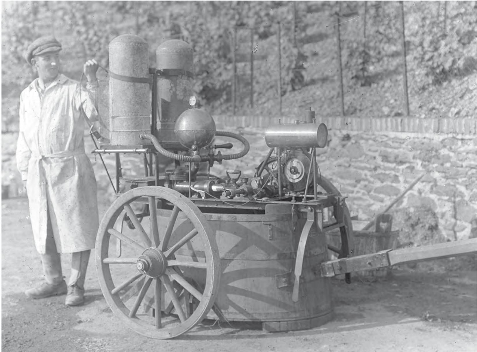
Motorbaumspritze „Motor-Rapid“ der Firma Platz, die zur Pferdebespannung vorgesehen ist. Bei einem Benzinverbrauch von 1l pro Stunde hat sie bei einem Druck von 25 bar eine Leistung von 40 l in der Minute.
