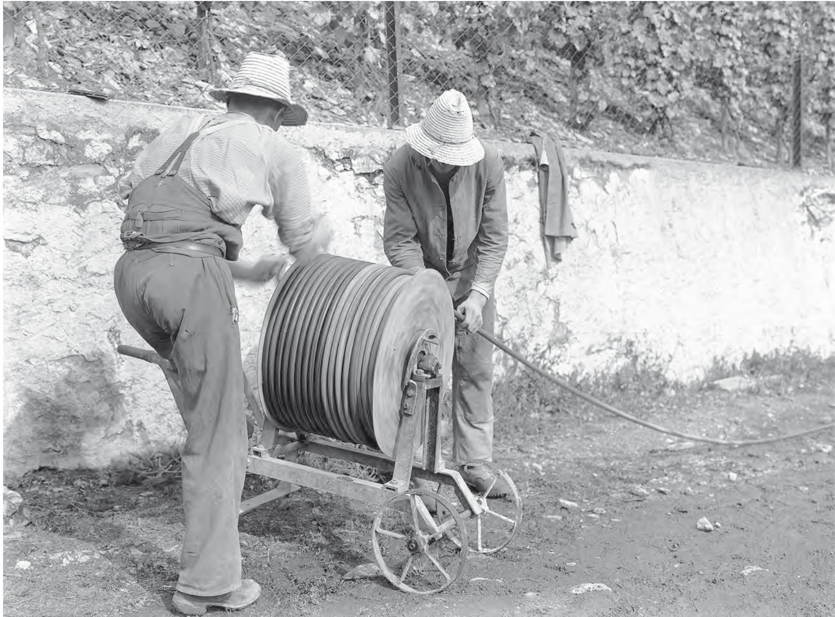
Handfüllpumpe „Fix“ Modell 1915 der Firma Holder, mit der Hochdruck- Batteriespritzen sowohl mit Druckluft als auch mit Spritzbrühe befüllt wurden. Mit Hilfe dieser Pumpe wurden die Batteriespritzen zuerst mit etwa 3 bar Luft gefüllt, um anschließend noch mit 22-30 Liter Spritzbrühe gefüllt zu werden, was einen Enddruck von 10 bar ergab. Mit diesem Druck konnte die komplette Spritzbrühemenge einer Batteriespritze ohne Nachfüllung von Luft verspritzt werden.
