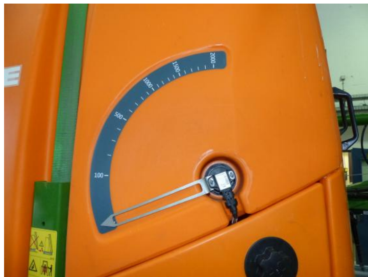
Abb.3: Inhaltsanzeiger am Gerät mit nichtlinearer Skala.
