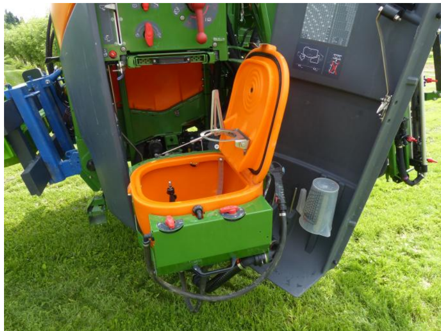
Abb.5: Linke Geräteseite mit Bedienzentrum und Einspülschleuse.
