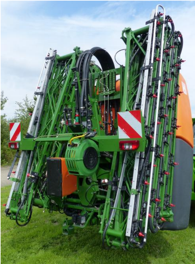
Abb.4: Zusammengeklapptes Gestänge am Geräteheck.
