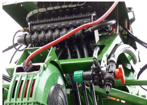
Abb.7: Ventilblock mit Druckregler und „DUS“ (dicker Schlauch im rechten Bildbereich).
