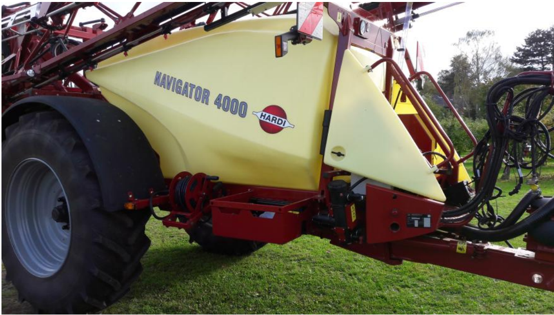
Abb.2: Rechte Geräteseite mit Reinigungslanze, Schlauchhaspel und Handwaschtank.
