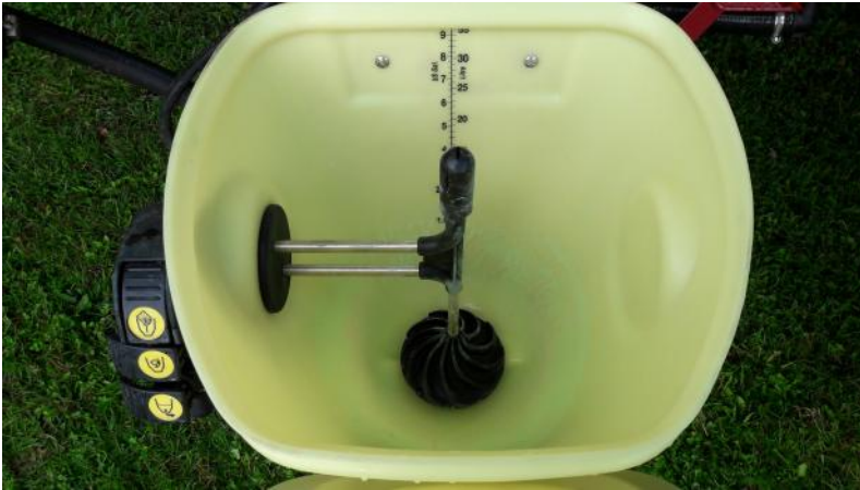
Abb.6: Einspülschleuse mit Bedienhebeln.
