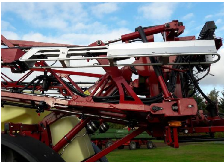
Abb.3: Gestängehebeeinrichtung „PARALIFT“ und äußeres Gestängesegment mit Düsenschießbügel.
