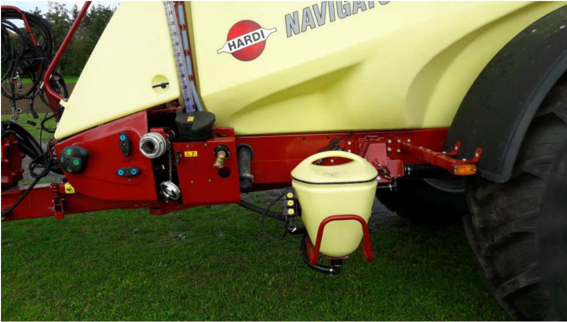
Abb.4: Linke Geräteseite mit Bedienfeld, Füllanschlüssen, Inhaltsanzeiger und Einspülschleuse.
