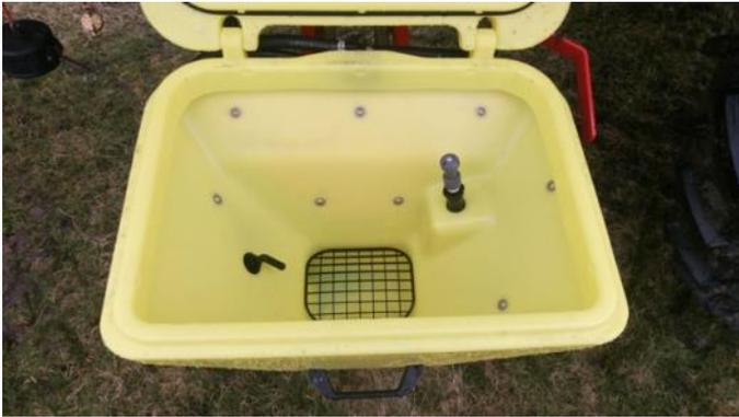
Abb.6: Ausgeklappte Einspülschleuse zum Einspülen von Pflanzenschutzmitteln und zum Reinigen leerer Pflanzenschutzmittelgebinde.
