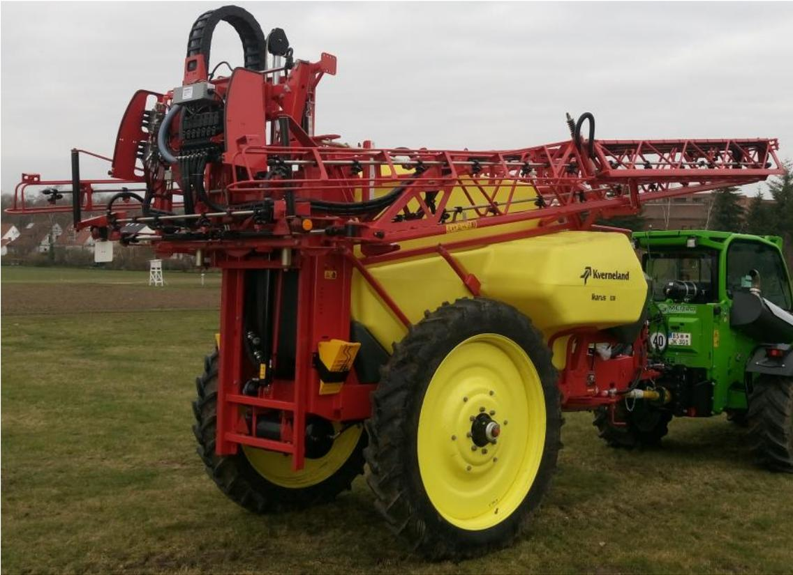
Abb.4: Gestängelifft mit seitlich geklapptem Gestänge.
