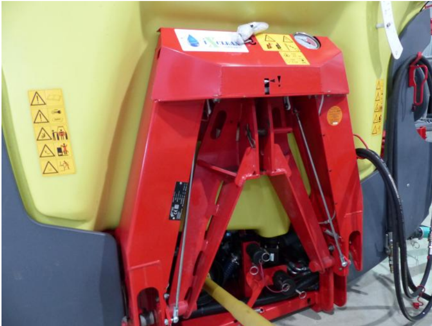
Abb.2: Schnellkupplungsrahmen mit analogem Manometer.
