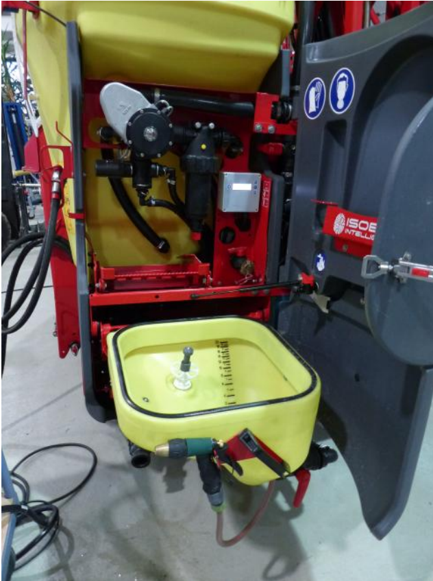
Abb.4: Linke Geräteseite mit Bedienfeld und ausziehbarer Einspülschleuse.
