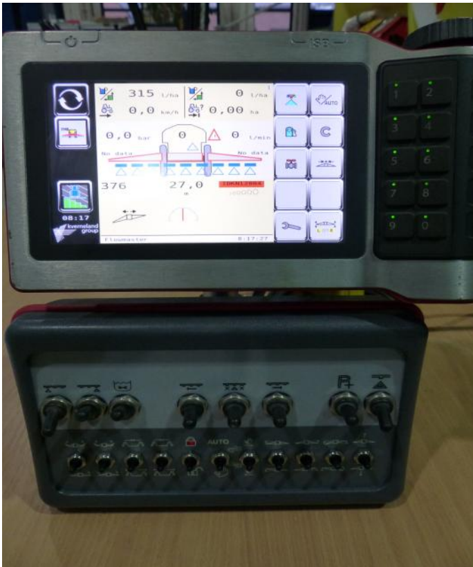
Abb.5: „ISO Match Tellus 60“ Bedieneinheit (ISO BUS) und manuelles Schaltbrett.
