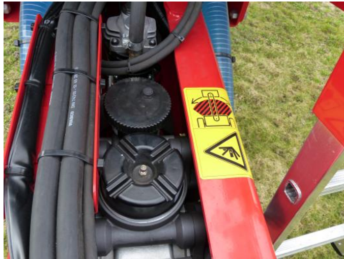
Abb.4: Zwei Spritzflüssigkeitspumpen „Altek P260“ in der Zugdeichsel.
