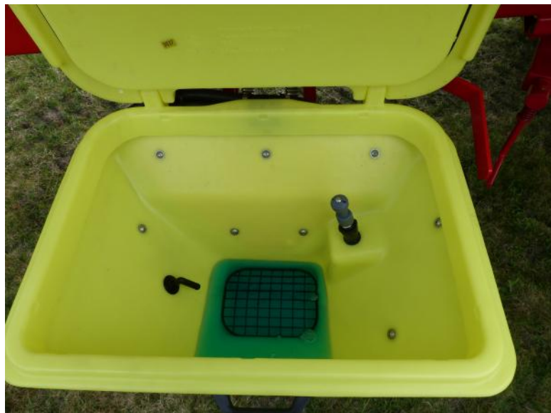
Abb.3: Ausgeklappte und offene Einspülschleuse auf der linken Geräteseite.
