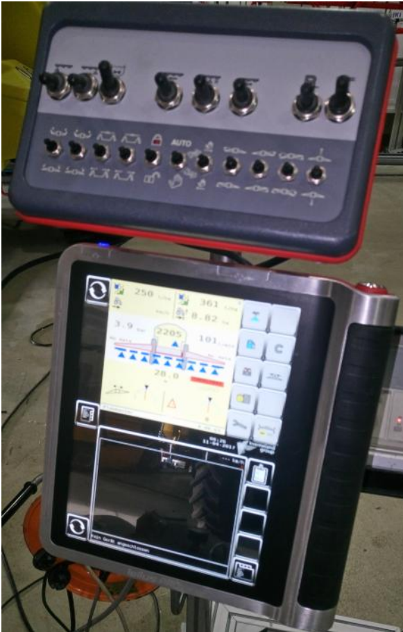
Abb.7: ISOBUS kompatibler Spritzcomputer „Tellus PRO“ mit Touchscreen und Schaltbrett zur manuellen Bedienung der Spritz- und Hydraulikfunktionen.
