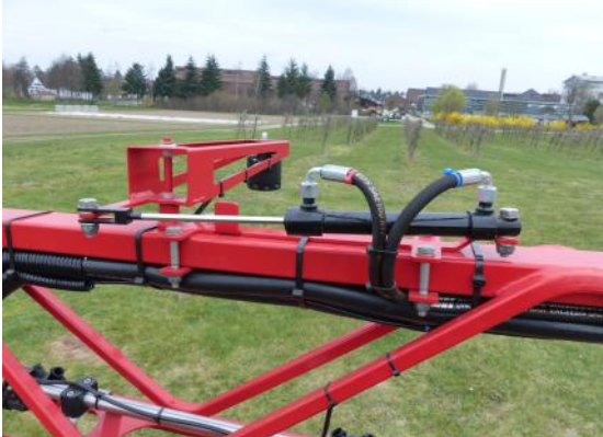
Abb.5/6: Unabhängige Neigungssteuerung der Gestängehälften. Ultraschallsensoren mit Hydraulikarm zum automatischen Drehen der Sensoren beim Einklappen des Gestänges.
