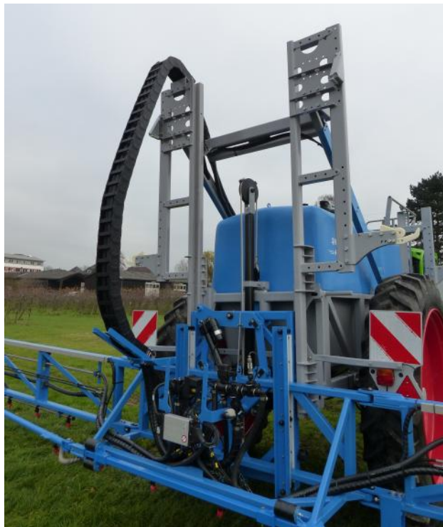
Abb.3: Stahlgestänge mit senkrechter Hubeinrichtung.
