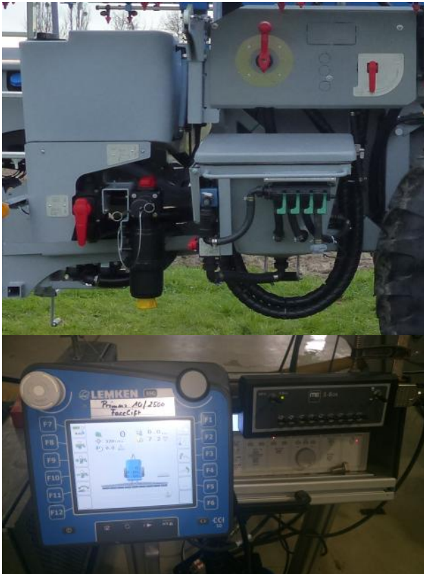
Abb.4/5: Linke Geräteseite mit Einspülschleuse, Bedienzentrum und Füllanschlüssen. Anzeige (blau) und Schaltereinheit (schwarz) für die Fahrerkabine.
