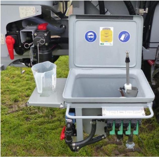
Abb.7: Einspülschleuse mit aufgestellter Rotationsdüse zur Gebindereinigung.
