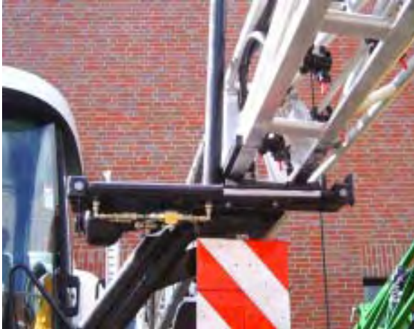
Abb. 8: Gestängeablage mit seitlicher Verschiebung zur besseren Erreichbarkeit der Kabine.
