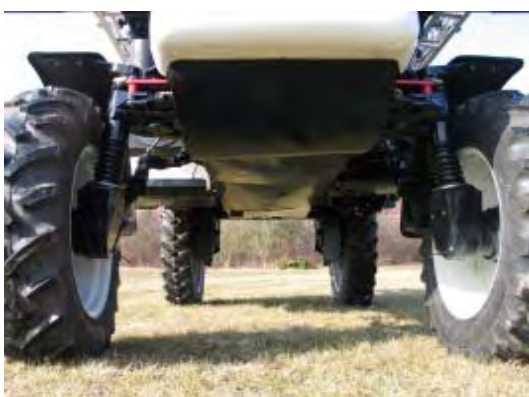
Abb.5: Glatt verkleideter Unterboden. Im Vordergrund die Vorderachse.
