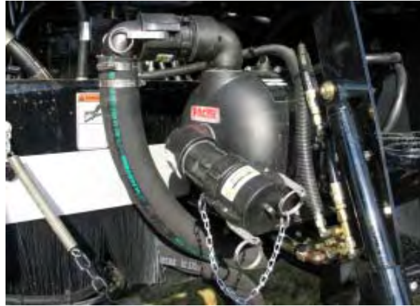
Abb. 6: Füllpumpe mit Kamlock -Anschluss. Am rechten Bildrand die Aufstiegsleiter.
