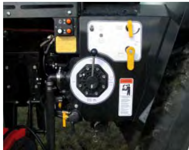
Abb.7: Bedienzentrum an der linken Fahrzeugseite mit Taster (orange) für Motordrehzahl.
