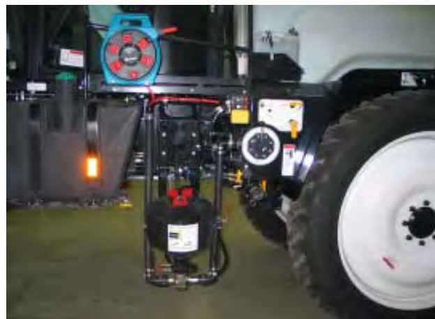
Abb.9: Linke Fahrzeugseite, mit heruntergeklappter Einspülschleuse (Bildmitte) und Schlauchtrommel zur Außenreinigung
