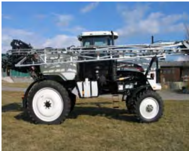
Abb.4: Seitenansicht rechts. Abgesehen vor dem Hinterrad zu sehen, der Spülwasserbehälter.
