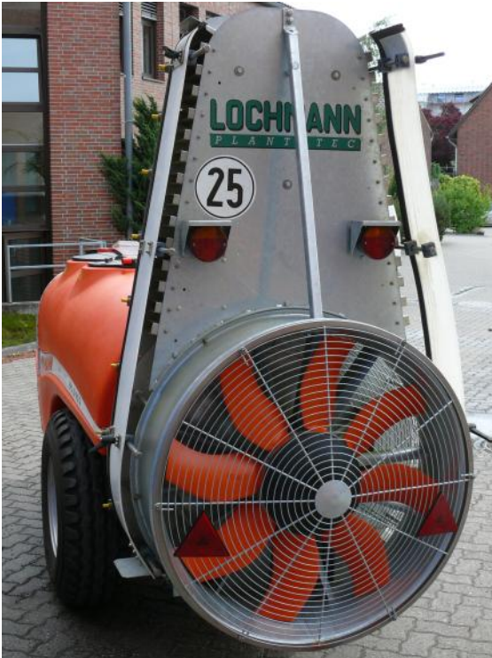
Abb.2: 900 mm Axialgebläse mit Luftleitgehäuse und manuellen „Luftabdeckungen“ (optional). Aktuell werden hydraulisch angetriebene Abdeckungen verbaut.
