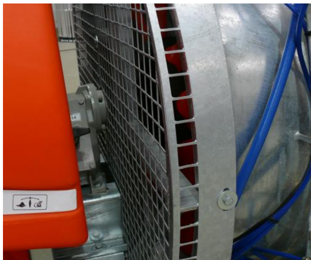
Abb.3: Lufteinlass und Getriebe des Rotors.
