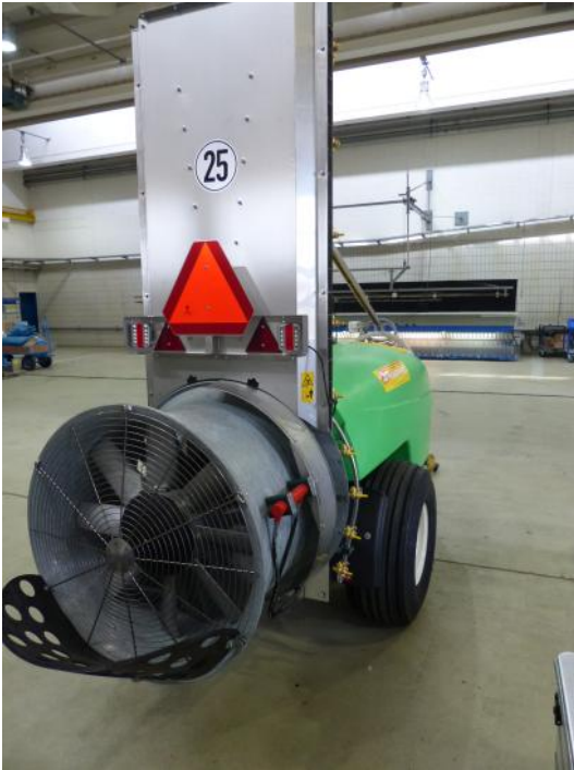
Abb.2: 810 mm Axialgebläse mit Blechaufbau zur Luftführung.
