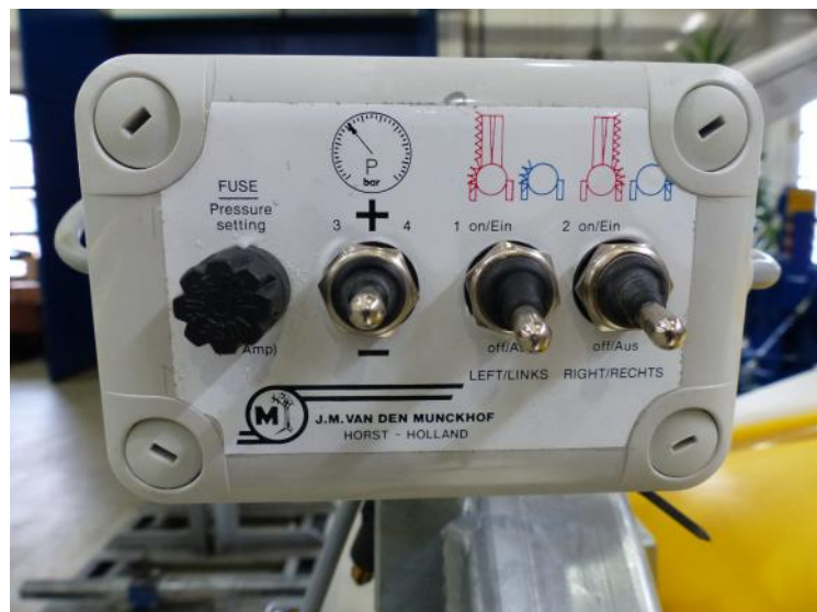
Abb.5: Fernbedienung zum Schalten der Düsen und zur Einstellung des Spritzdrucks.
