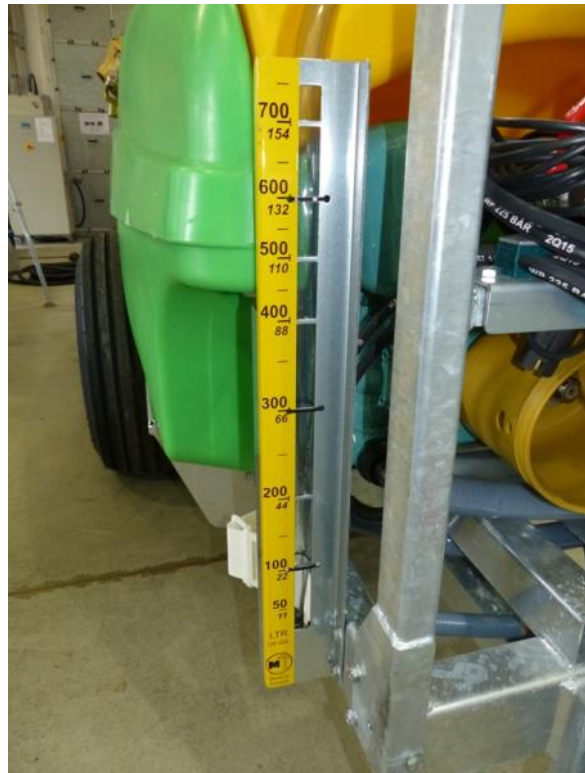
Abb.3: Inhaltsanzeiger (Prinzip Steigrohr) an der Tankfront.
