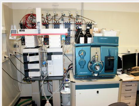
Analysegerät zur qualitativen und quantitativen Bestimmung von Biozid- und PSM- Wirkstoffen. Sensitive measurement instruments (LC\_MS/MS) for qualitative and quantitative detection of residues.
