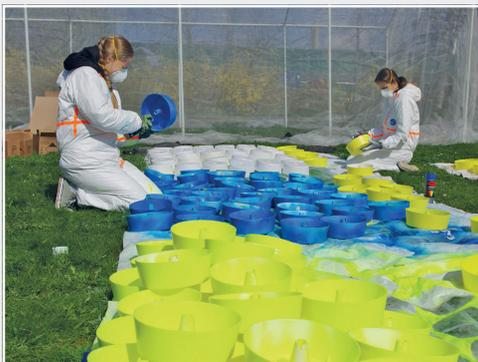
Farbfangschalen zur Erprobung verschiedener Methoden für langfristiges Wildbienenmonitoring.
