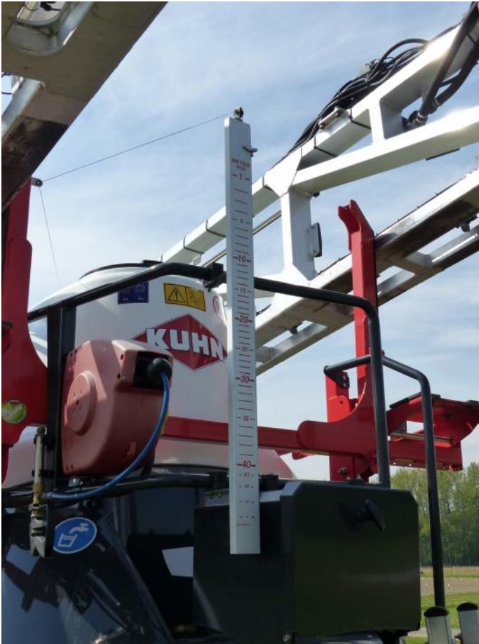
Abb.2: Vordere rechte Geräteseite mit mechanischen Inhaltsanzeiger und Spritzlanze zur äußerlichen Gerätereinigung.
