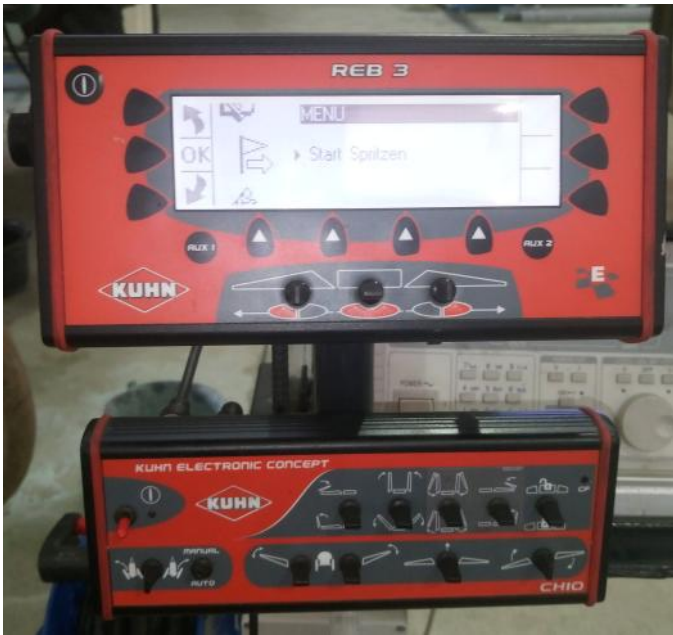
Abb.6: Im Vordergrund: Anzeige (REB 3) und Schaltbrett für die Hydraulikfunktionen (CH10) in der Fahrerkabine.
