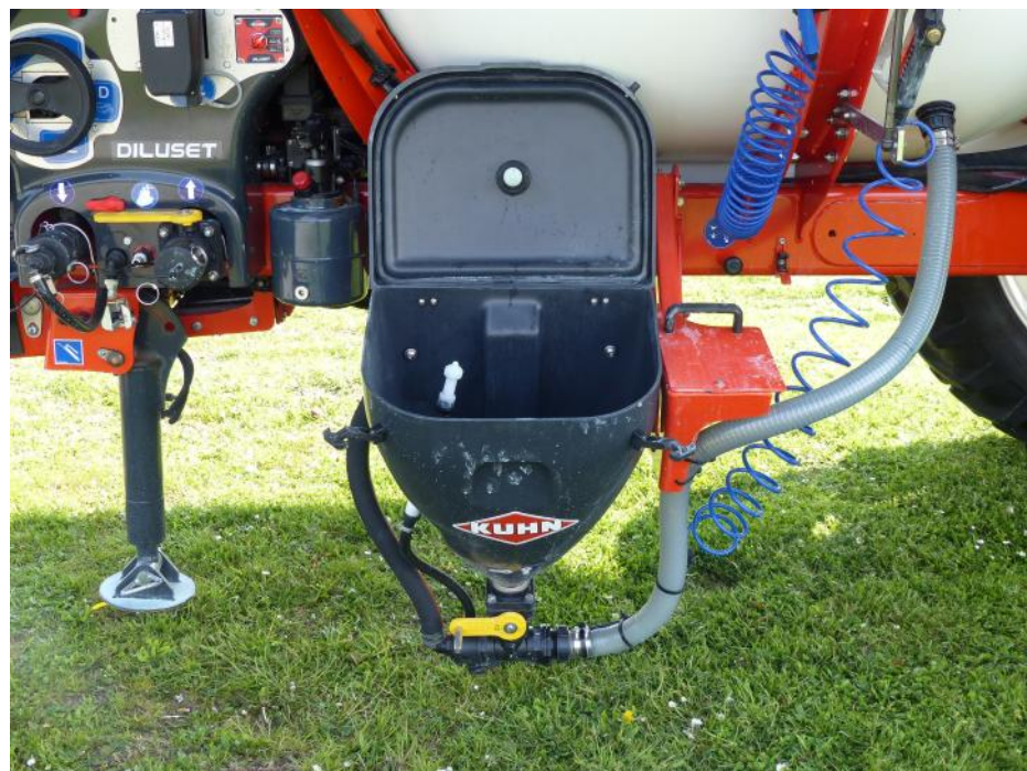
Abb.5: Linke Geräteseite mit ausgeklappter Einspülschleuse.
