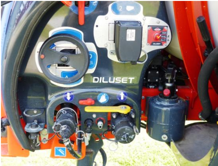
Abb.4: Bedienzentrum an der linken Geräteseite.
